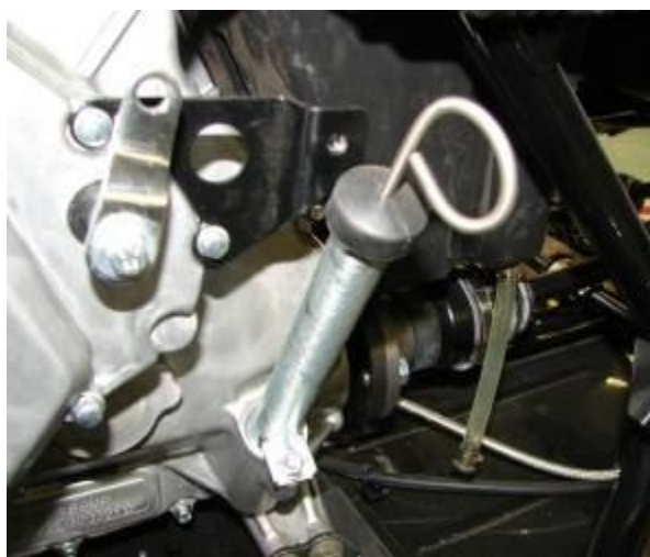
Рисунок 17 - Расположение масляного щупа на двигателе
