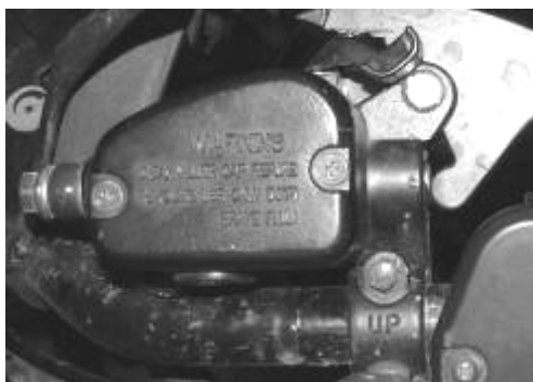
Рисунок 26 - Крышка главного тормозного цилиндра
