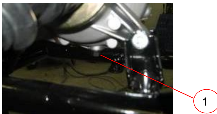
1 – пробка сливного отверстия
