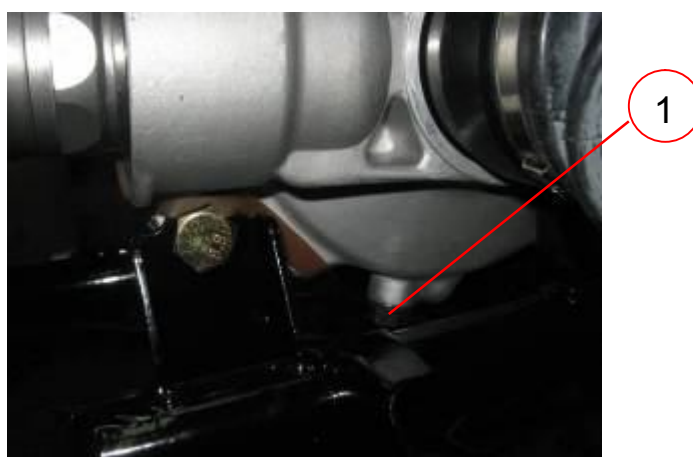
1 – пробка сливного отверстия
