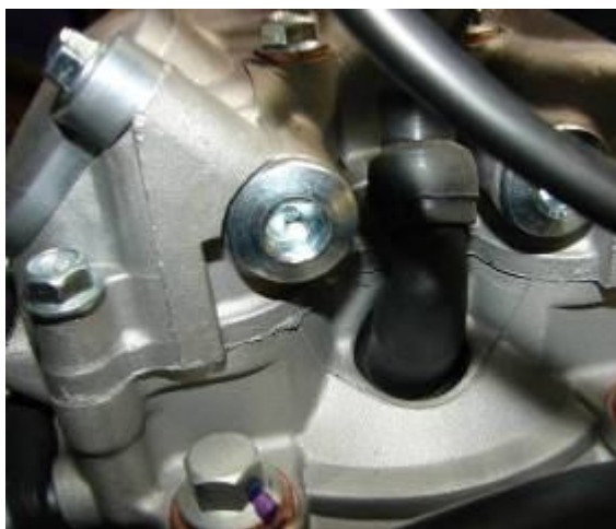
Рисунок 27 - Колпачок свечи зажигания
